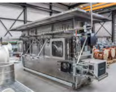
Caseta de analizadores
